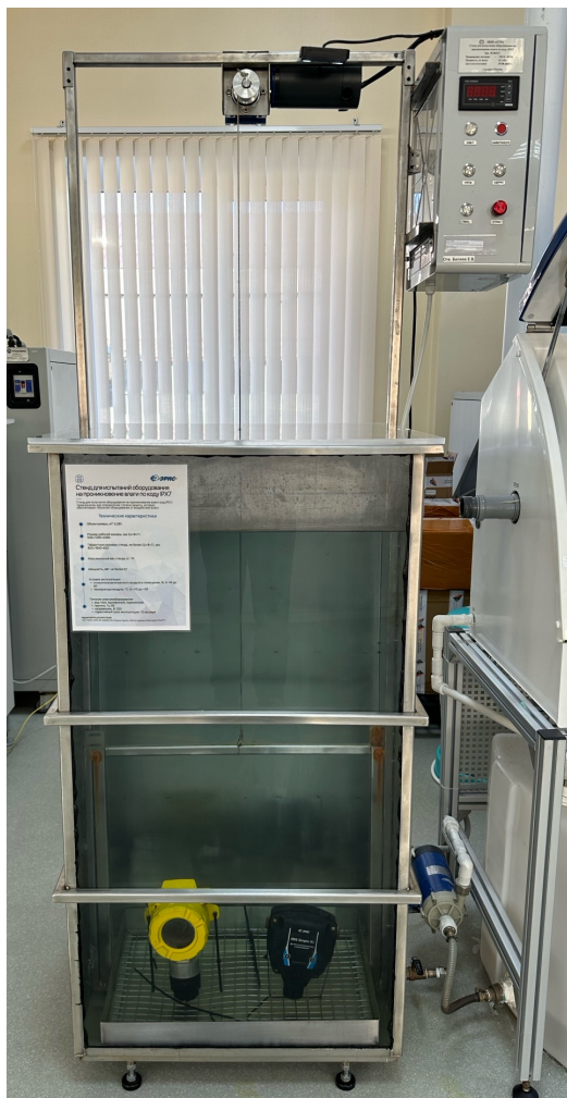
Стенд для испытаний оборудования на проникновение влаги по коду IPX7
