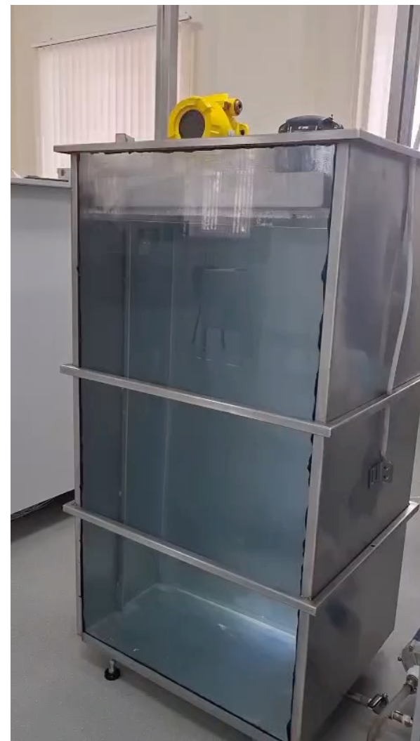
Стенд для испытаний оборудования на проникновение влаги по коду IPX7
